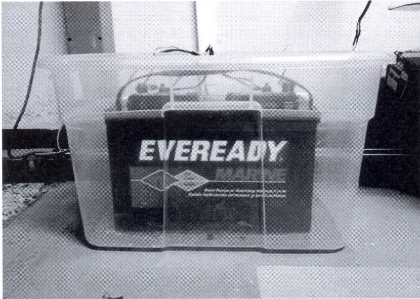
Imagen 5-3: Batería de ciclo profundo instalada en el laboratorio de Mecatrónica, vista de elevación.
