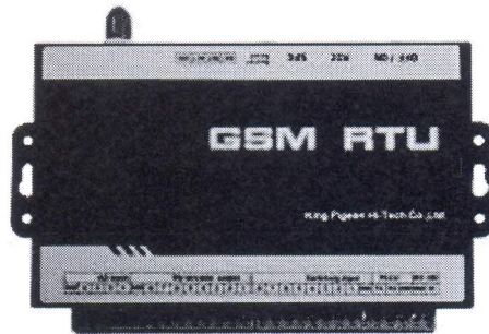
Imagen 5-7: GSM RTU-5011 Vista planta
