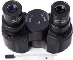
Para personalizar el microscopio para su comodidad de visualización, el espaciado del ocular se puede ajustar fácilmente utilizando un mecanismo Siedentopf de precisión. Una dioptria está disponible en el tubo ocular izquierdo para compensar la asimetría, y los tubos oculares están en ángulo a 30° para acomodar cómodamente una posición sentada sin tensión en el cuello. Se pueden usar varios oculares para aumentar el aumento óptico general.
