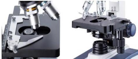
La etapa mecánica de 2 capas proporciona un movimiento suave y preciso para el examen de portaobjetos de muestras. Los controles de posición baja del escenario están convenientemente colocados cerca de las perillas de enfoque coaxial para un flujo de trabajo optimizado. El examen de las diapositivas de muestras es intuitivo y preciso para los usuarios de cualquier nivel de habilidad.
