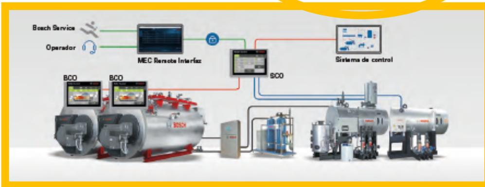
El sistema ofrece una vista general de varias calderas ubicadas alrededor del mundo lo que permite su monitorización al mismo tiempo. El módulo SMS opcional envía notificaciones predefinidas cada vez que se produce un error. Esto reduce el esfuerzo de supervisión en plantas con requerimientos específicos de alta fiabilidad p.ej. en operación continua.
