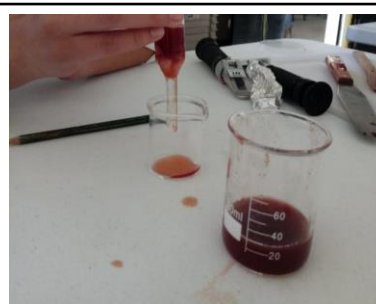
Fotografía 4: Filtrado de la pectina ya filtrada estará lista para utilizar y también para medir el pH el cual tiene que estar en 3.
