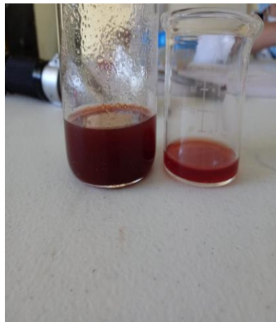
Fotografía 2: En el segundo paso se realizó una dilución de agua acidulada que fue agua + ácido cítrico. Lo cual se calentó por 30 minutos a 90°C hasta concentrar.
