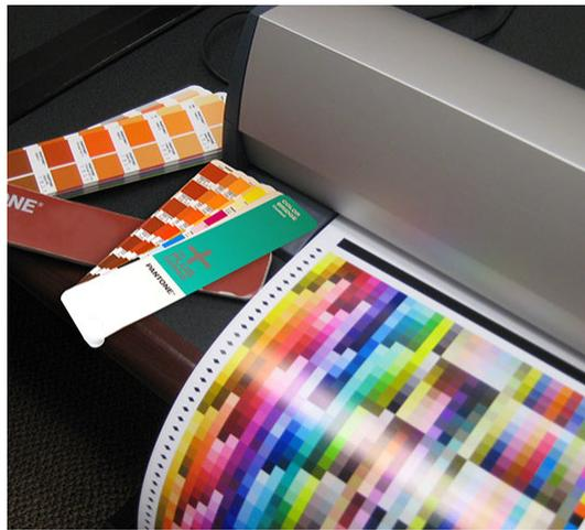
Fotografía: Proceso de impresión para una prueba de color en base a pantones de pantalla
