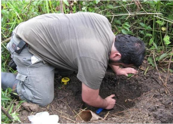
Obteniendo muestras de suelo para medición de carbono
