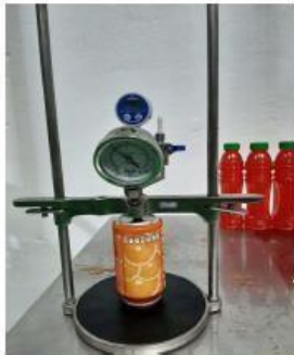
Prueba de presión y temperatura en Carbotester
