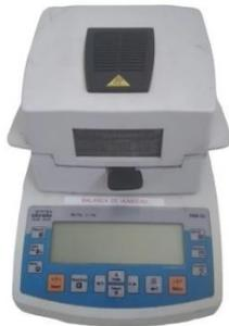
Balanza de humedad marca radwag
