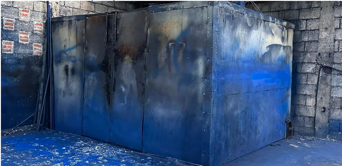
Ilustración 51. Horno para pintura
