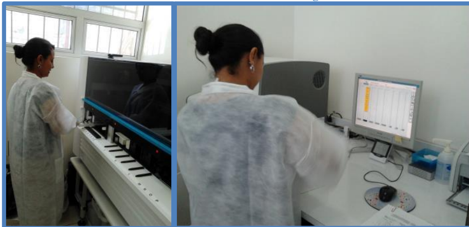
Fotografía 1: Determinación de carga viral plasmática de VIH-1 utilizando la prueba COBAS Ampliprep/Taqman HIV-1 v.2.0 de Roche Molecular Diagnostics
